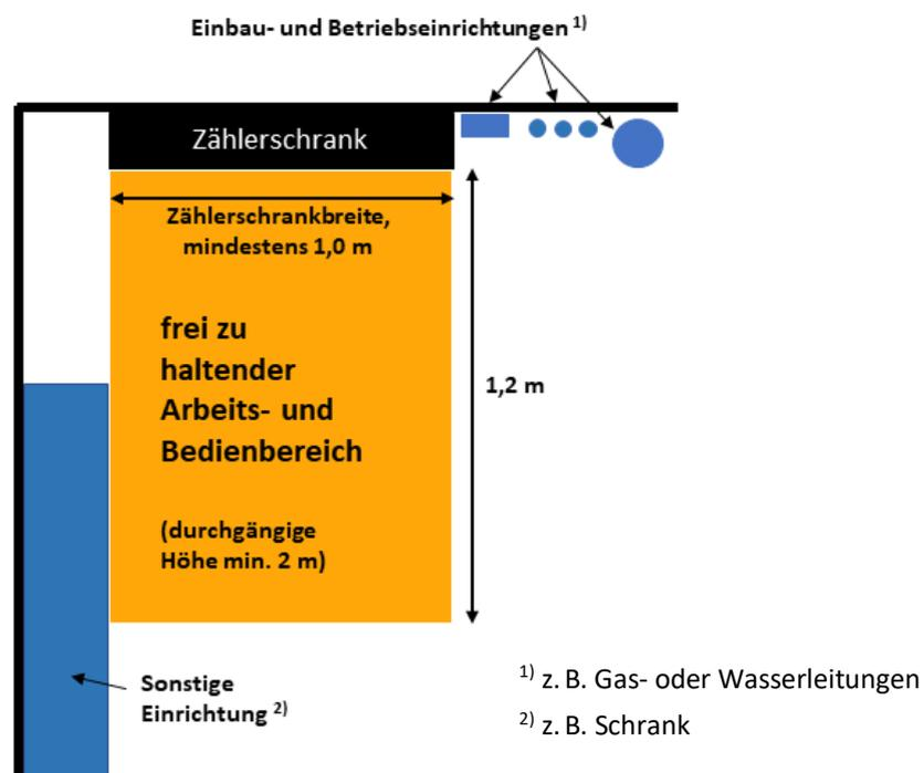
Abbildung 3: Arbeits- und Bedienbereich vor dem Zählerschrank
