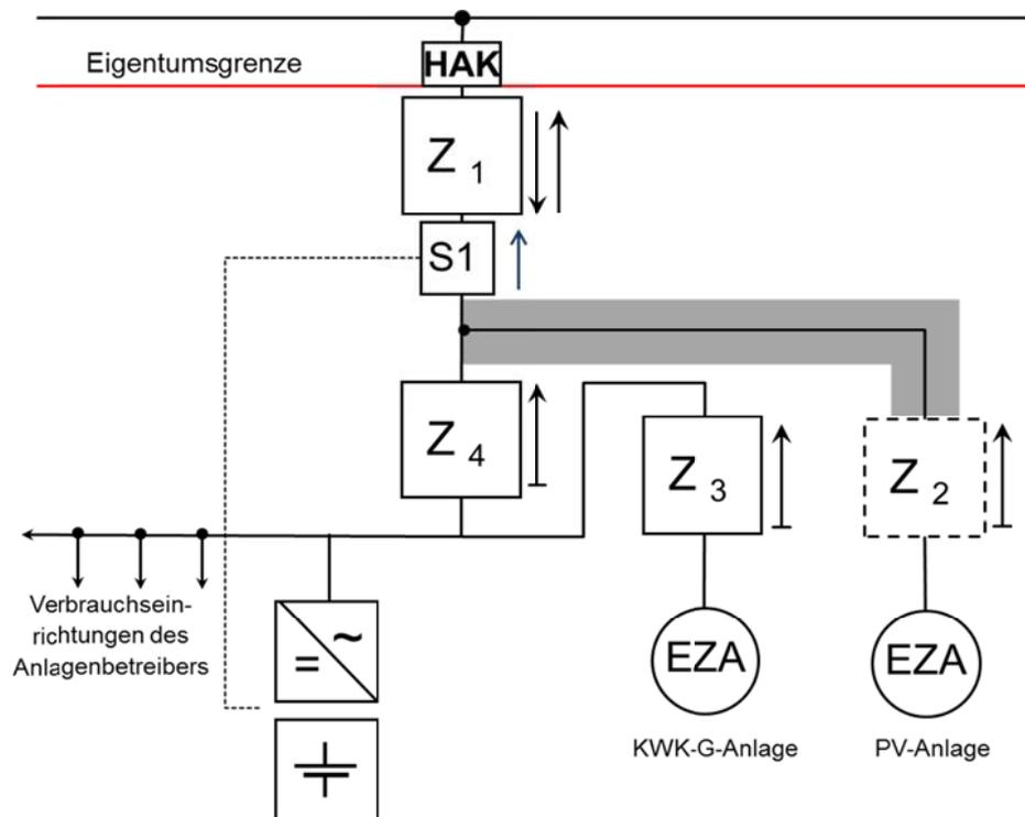
Abbildung 9: Speichersystem im Verbrauchspfad mit KWK-Anlage
