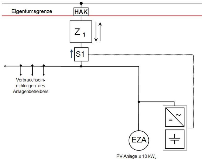
**Abbildung 6: Speichersystem im Erzeugungspfad, EZA (PV) kleiner 10 kW<sub>p</sub>**
