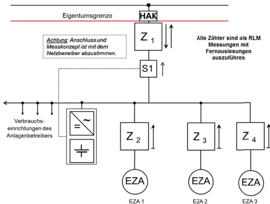
**Abbildung 13: Komplexes Anschlussbeispiel mit mehreren EZA und einem Speichersystem in der Kundenanlage bei höheren Leistungsgrenzen**
