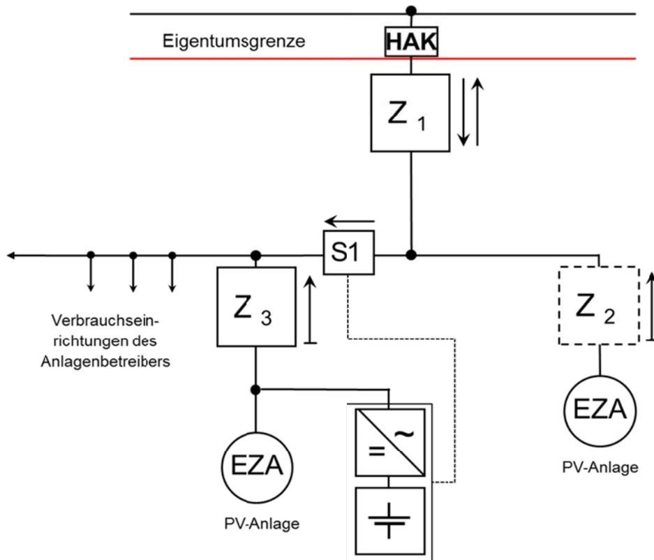
Abbildung 4: Speichersystem im Erzeugungspfad mit weiterer EZA
