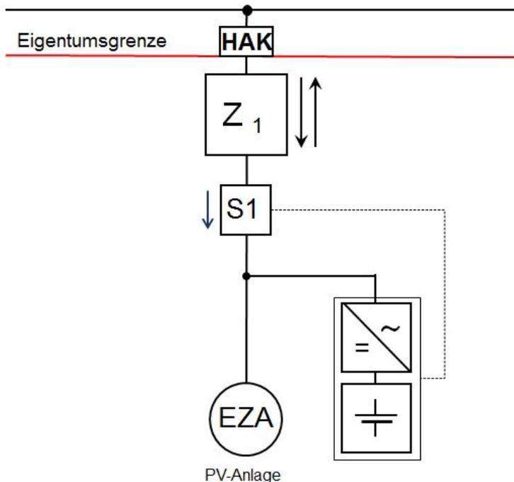
Abbildung 2: Erzeugungsanlage mit Speicher ohne Verbrauchseinrichtung
