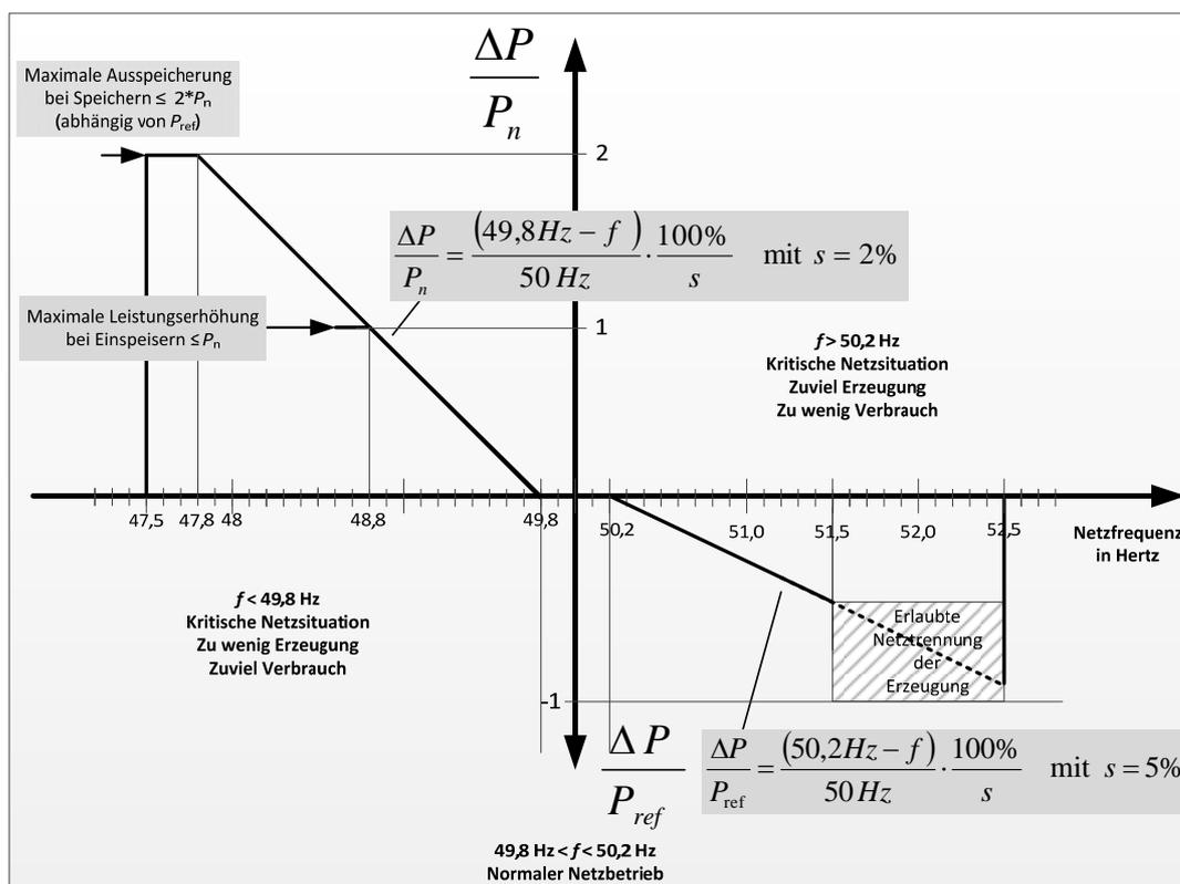
**Abbildung 1: Anforderungen an das Wirkleistungsverhalten bei Unter-/Überfrequenz**
